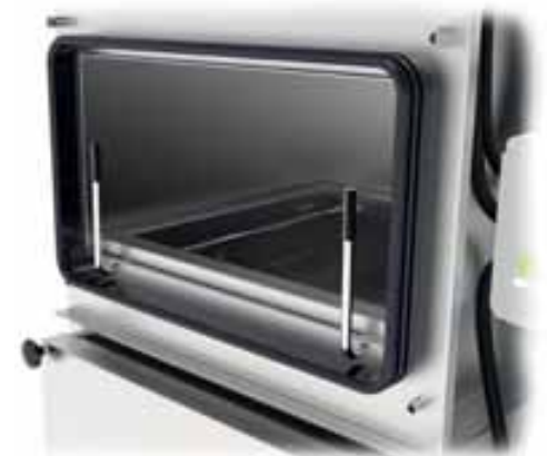
Safe Change, Bag-In-Bag-Out Filterkammer mit 2-Rillen Wartungsbord
