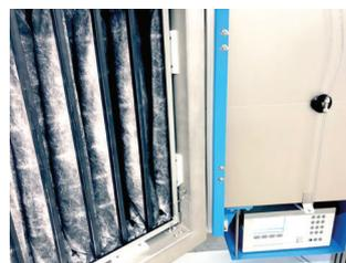
Für die Filterprüfprotokolle sind alle in der Tabelle Klasseneinteilung gem. ISO 16890 aufgeführten Wirkungsgrade mit den Messwerten-E(ePMx) angegeben. Diese sind in Pentaden gerastert. Die Messwerte werden hierfür abgerundet und die Filterklasse ergibt sich aus der entsprechenden Einordnung.
