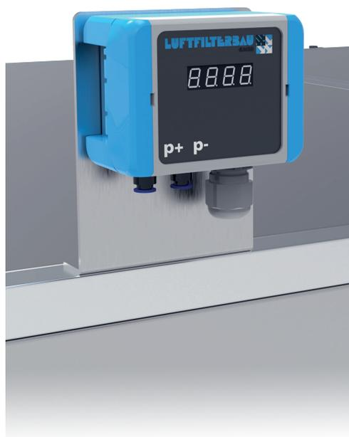
Der HS-Differenzdruckmessumformer dient zur Messung von Differenzdrücken. Er erfasst den Differenz-, Über- und Unterdruck zwischen den zwei Druckeingängen und wandelt den Messwert in ein lineares oder radiziertes Ausgangssignal von 0(4)...20 mA bzw. 0...10 V um. So kann eine Aussage zum Beladungsgrad von Filtern getroffen und z.B. an eine Steuerung oder Leitstelle übertragen werden. Der Umformer wird in drei Varianten angeboten (s.u.).
