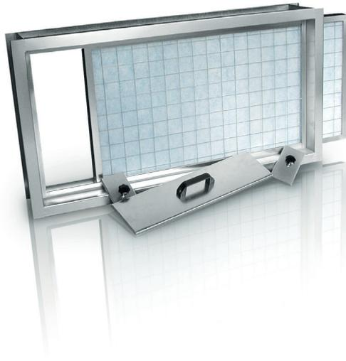
Der HS-Zellenkanalfilter Typ HS-Z035 (flach) besteht aus einem Gehäuse mit Revision-sdeckel und dem Einschub-Schnellwechselrahmen mit Stützgitter und Andruckspanne. Das Gehäuse ist aus verzinktem Stahlblech, optional auch aus Edelstahl, gefertigt. Der umlaufende wahlweise 30, 40 oder 50mm Anschlussflansch kann bauseits mit Bohrungen versehen werden, um problemlos an gängige Kanäle angeschlossen zu werden. Überdies sind beliebige Übergangsstücke, z.B. auf Rohrkanäle, möglich.
