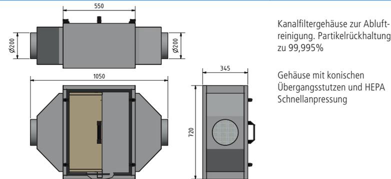
Kanalfiltergehäuse zur Abluftreinigung. Partikelrückhaltung zu 99,995%
