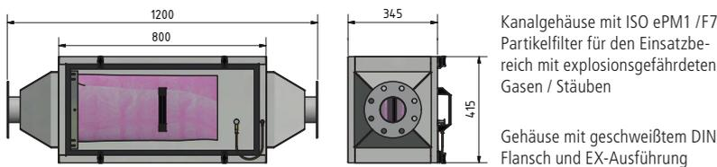
Kanalgehäuse mit ISO ePM1 /F7 Partikelfilter für den Einsatzbereich mit explosionsgefährdeten Gasen / Stäuben
