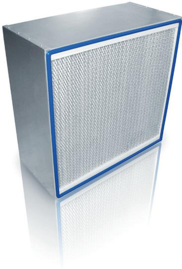
HS-Fogdrain Filter eignen sich für die Abscheidung von Nebeln, Dämpfen sowie für die Filtration von feuchten Aerosolen und Stäuben. Diese entstehen z.B. beim Härten, Kaltziehen, Schleifen mit Öl, CNC Drehen, Warm- und Kaltpressen sowie beim Druckguss.
