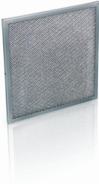
HS-Fettfangfilter sind für den Einsatz im Küchenbereich konzipiert. Bei der Zubereitung von Speisen werden Fette verwendet bzw. freigesetzt. Diese Fette werden in hohen Anteilen vom Wasserdampf aufgenommen. Wenn dieser fetthaltige Dampf über die Metallfilter abgesaugt wird, so kondensiert das Speisefett an dem Drahtgestrick (große Kühlflächen) in den Metallfilterzellen.
