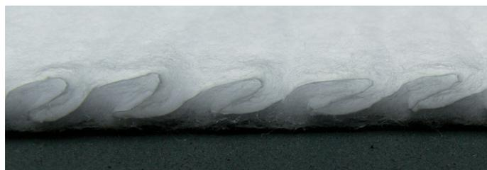
Gut zu erkennen: die Wellenstruktur des Filtermediums im Querschnitt bietet **ca. 2,5-fache Filterfläche auf gleichem Bauraum**.
